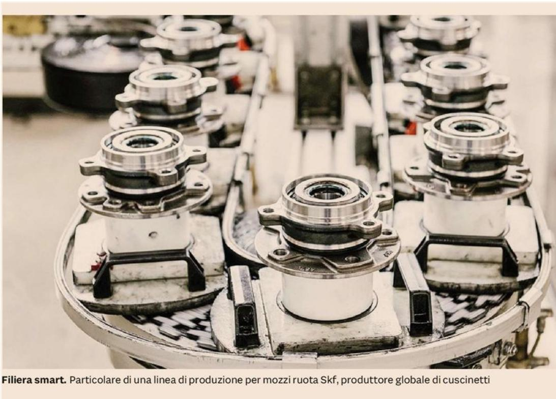
**Filiera smart.** Particolare di una linea di produzione per mozzi ruota Skf, produttore globale di cuscinetti
